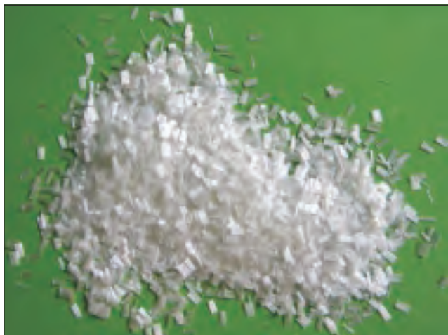
Rys. 4. Rowing szklany, cięty ER 5001/4,5/15
