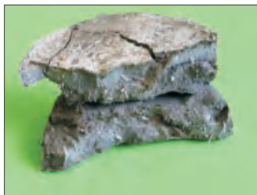
Rys. 12. Kamień cementowy z dodatkiem 3% włókna szklanego ER 5001/4,5/15
