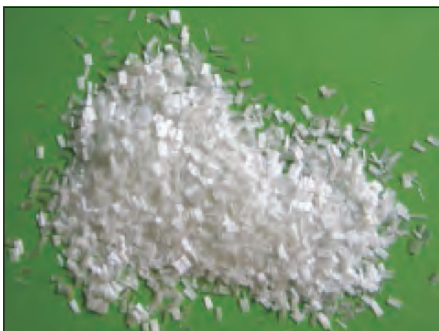
Rys. 3. Rowing szklany, cięty ER 2011/4,5/15
