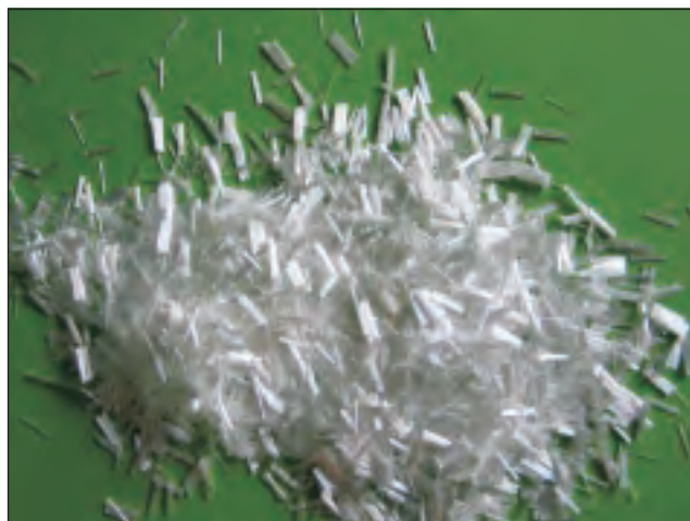
Rys. 5. Rowing szklany, cięty ER 6001/6/13
