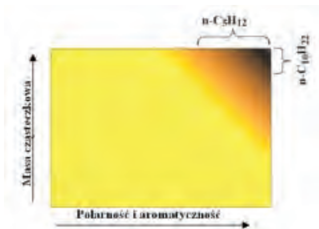
Rys. 4. Diagram pokazujący różnice w wytrącaniu z ropy naftowej asfaltenów, o różnej masie cząsteczkowej, polarności i aromatyczności, w zależności od użytego czynnika strącającego [5]
