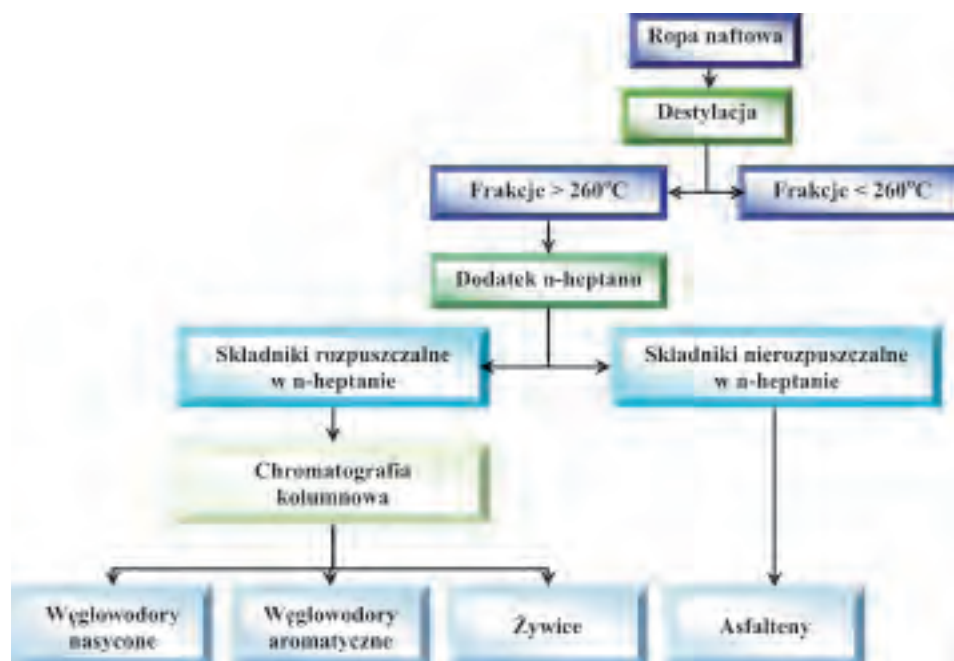
Rys. 2. Schemat oznaczania składu grupowego ropy naftowej (węglowodory nasycone, aromatyczne, żywice, asfalteny) z wykorzystaniem metodyki SARA
