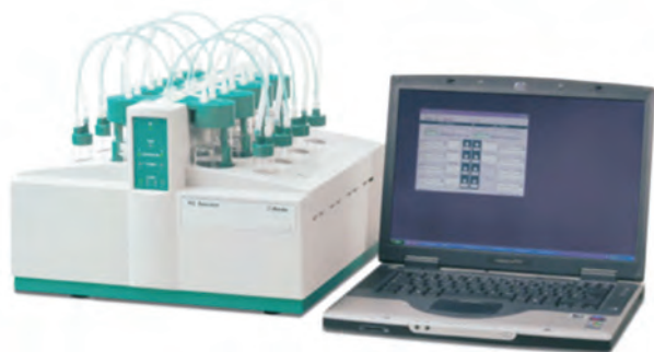
Rys. 2. Aparat do oznaczania odporności na utlenianie biodiesla zgodnie z normą EN 14112 [4]
