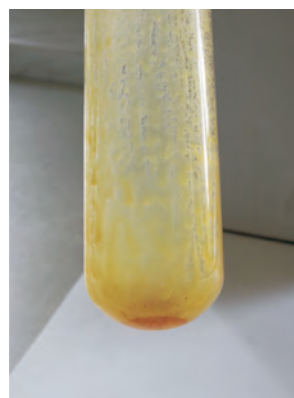
Rys. 5. Wygląd próbki pokrytej żelem. Badanie paliwa z biokomponentem, wykonane zgodnie z normą ISO 12205 [fot. INiG Kraków]
