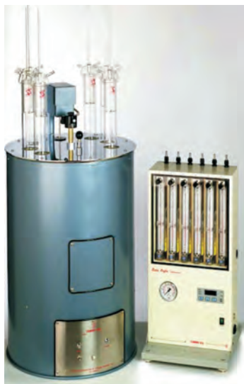
Rys. 1. Aparat do badania odporności na utlenianie według ISO 12205 [2]
