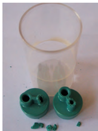
Rys. 4. Elementy wykonane z tworzywa sztucznego, uszkodzone w wyniku oddziaływania biodiesla i produktów jego utleniania (wyposażenie aparatu Rancimat) [fot. INiG Kraków]
