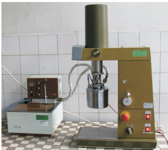
Fot. 1. Wiskozymetr rotacyjny Rheotest 2 wraz układem termostatującym (fot. autora)
