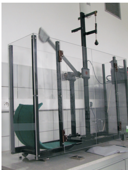
Rys. 1. Urządzenie pomiarowe do oznaczania kohezji metodą testu wahadłowego według PN-EN 13588 [INiG Kraków]
