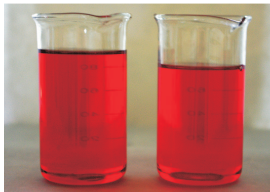
Rys. 1. Lekki olej opałowy zabarwiony czerwonym barwnikiem. Od lewej: Solvent Red 164 i Solvent Red 19
