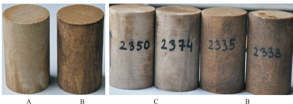
Rys. 5. Wygląd rdzeni po wypieraniu – A) 0,5-proc. (obj.) N1, B) 2-proc. NaCl, C) 0,5-proc. (obj.) N2
