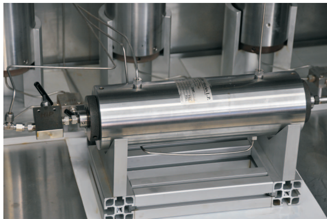
Rys. 2. Stanowisko do badań przepływowych AFS Core Flood System oraz uchwyt na rdzenie
