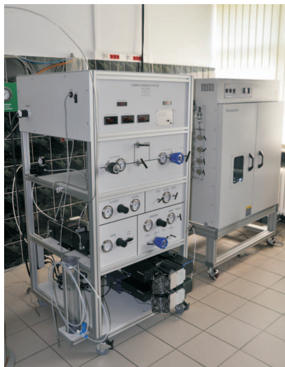
Rys. 2. Stanowisko do badań przepływowych AFS Core Flood System oraz uchwyt na rdzenie
