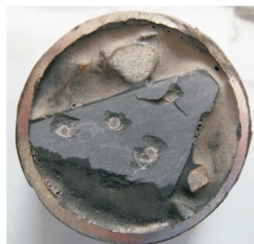
Fot. 1. Próbkę skały po przeprowadzeniu badania skałomierzem
