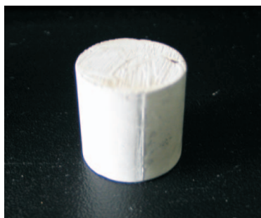
Fot. 2. Przykładowa próbka kamienia cementowego do badania przepuszczalności
