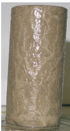
Rys. 4. Osad po przemyciu cieczą przemywającą
