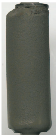
Rys. 3. Wytworzony osad na próbce rdzenia
