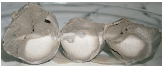
Rys. 8. Uszkodzone rdzenie z łupku miocenijskiego w czasie tworzenia osadu z płuczki bentonitowej
