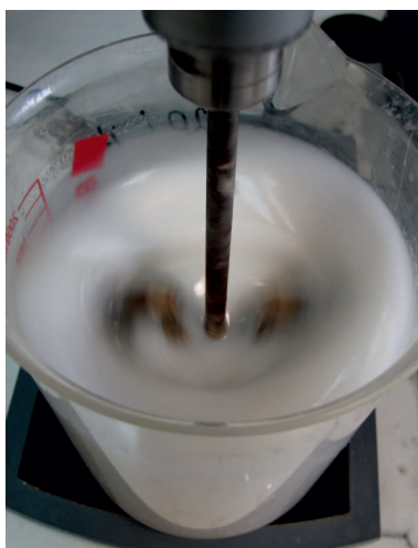
Fot. 3. Wytwarzanie osadu płuczkowego na rdzeniach
