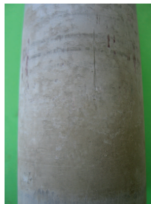
Fot. 4. Makroskopowa struktura płaszczu cementowego (struktura jednolita)
