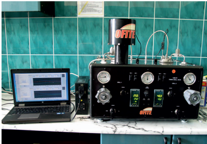
Fot. 1. Dwukomorowy ultradźwiękowy analizator cementu z miernikiem statycznej wytrzymałości strukturalnej umożliwiającym określenie czasu transition time
