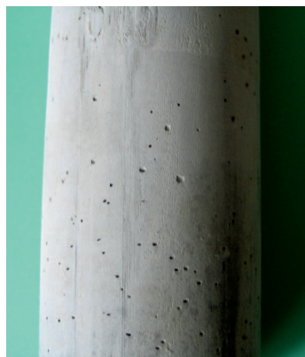
Fot. 2. Makroskopowa struktura płaszczu cementowego (widoczne kanalki w strukturze)
