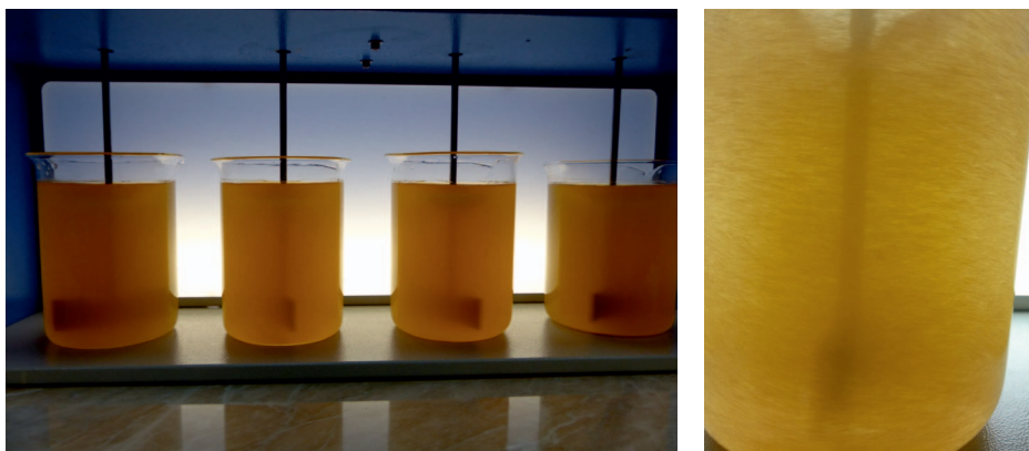
Rys. 1. Woda surowa przygotowana do badań procesu koagulacji i etap szybkiego mieszania z udziałem koagulantu. Widoczne powstające klaczki osadów (fot. P. Jakubowicz)
