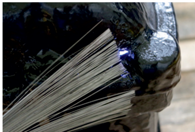
Fot. 5. Przebitej izolacji PUR na skutek przyłożonego napięcia próbnego (fot. T. Minor)
