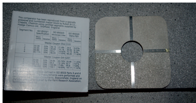
Fot. 2. Sprawdzenie przygotowania powierzchni (fot. T. Minor)
