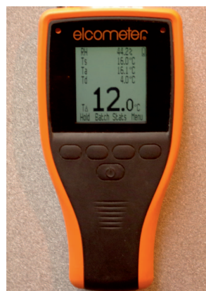
Fot. 2. Sprawdzenie przygotowania powierzchni (fot. T. Minor)
