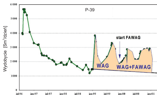
Rys. 11. Przebieg wydobywania na polu Snorre na przykładzie odwiertu P-39 (Blaker et al., 2002)
