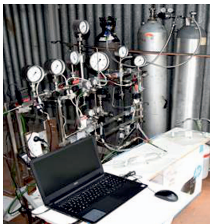
Rys. 2. Zdjęcie instalacji do badania rozdzielania mieszaniny gazu zawierającego hel na module membranowym
