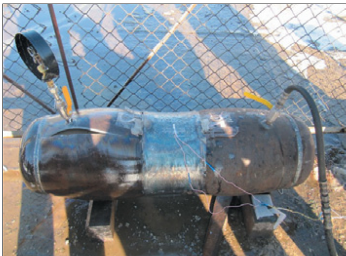
Rysunek 10. Zniszczony odcinek rurociągu o średnicy 325 mm z rękawem i wadą sztuczną
