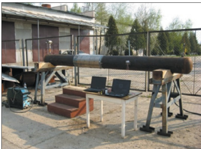
Rysunek 8. Stanowisko doświadczalne do badań hydraulicznych uszkodzonych odcinków rurociągów pod kątem wytrzymałości
