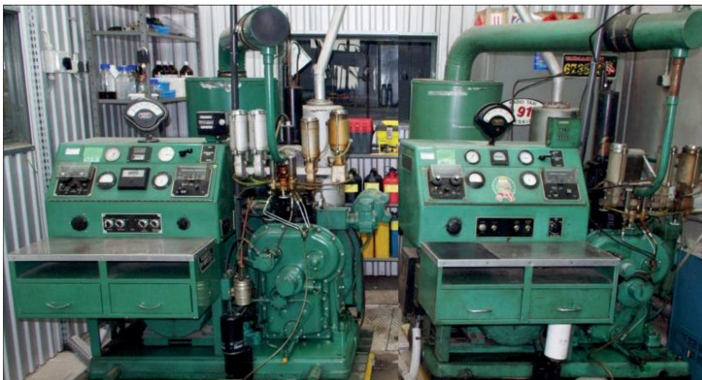
Rysunek 1. Stanowiska silnikowe CFR firmy Dresser Waukesha (USA) do oznaczania liczb oktanowych motorowej i badawczej (fot. INiG – PIB)
