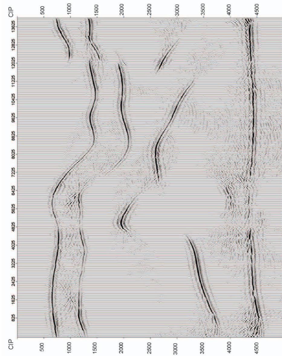
Rys. 6.14. (b) Sekcja sejsmiczna po migracji zerooffsetowej z uwzględnieniem anizotropii z parametrami jak w (a)
