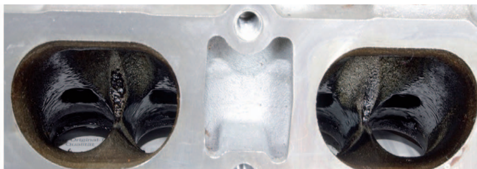
Rys. 4. Osady w kanałach dolotowych silnika Ford 1.8L Duratec-HE PFI FFV (125PS) M14 zasilanego nieuszlachetnionym paliwem E85
