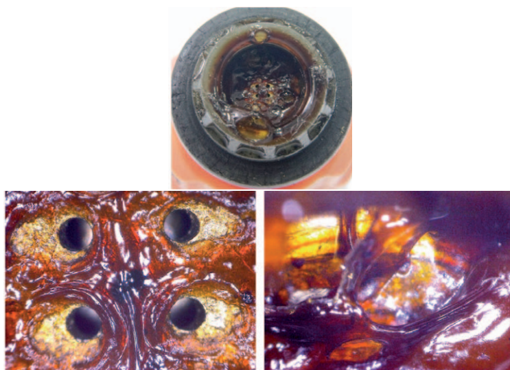
Rys. 5. Widok osadów na końcówce rozpylacza silnika Ford 1.8L Duratec-HE PFI FFV (125PS) zasilanego niewłaściwie uszlachetnionym paliwem E85
