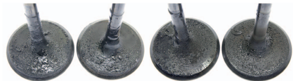
Rys. 2. Osady na zaworach dolotowych silnika Ford 1.8L Duratec-HE PFI FFV (125PS) MI4 zasilanego nieuszlachetnionym paliwem E85. Masy osadów na zaworach kolejno od lewej: 160 mg, 152 mg, 135 mg, 127 mg
