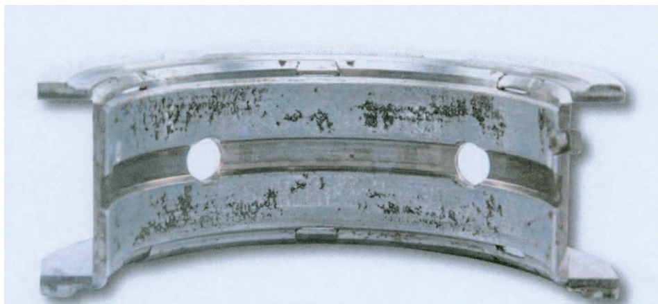
Rys. 8. Skutki agresywnego oddziaływania bioetanolu przedostającego się do smarowego oleju silnikowego na panewki łożysk wału korbowego [13]
